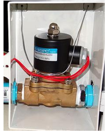
ภาพที่ 8 แสดงอุปกรณ์ต่อกับ วาล์วปิดเปิดน้ำ
